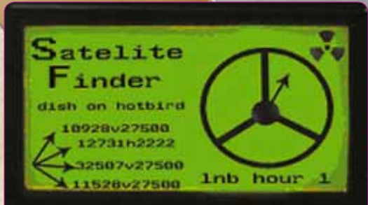
■ Дисплей интеллектуального средства спутникового поиска, показывающий самые сильные транспонеры наряду с углом компенсации наклона маломощного приемного блока (LNB).
