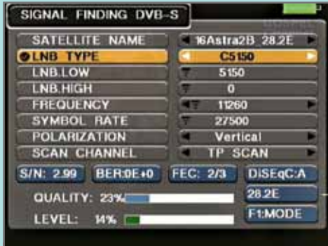
Предопределены различные значения локального осциллятора частоты (LOF) |
