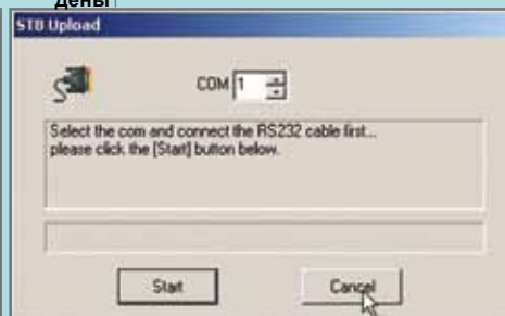
Последовательный интерфейс связывает анализатор с ПК!
