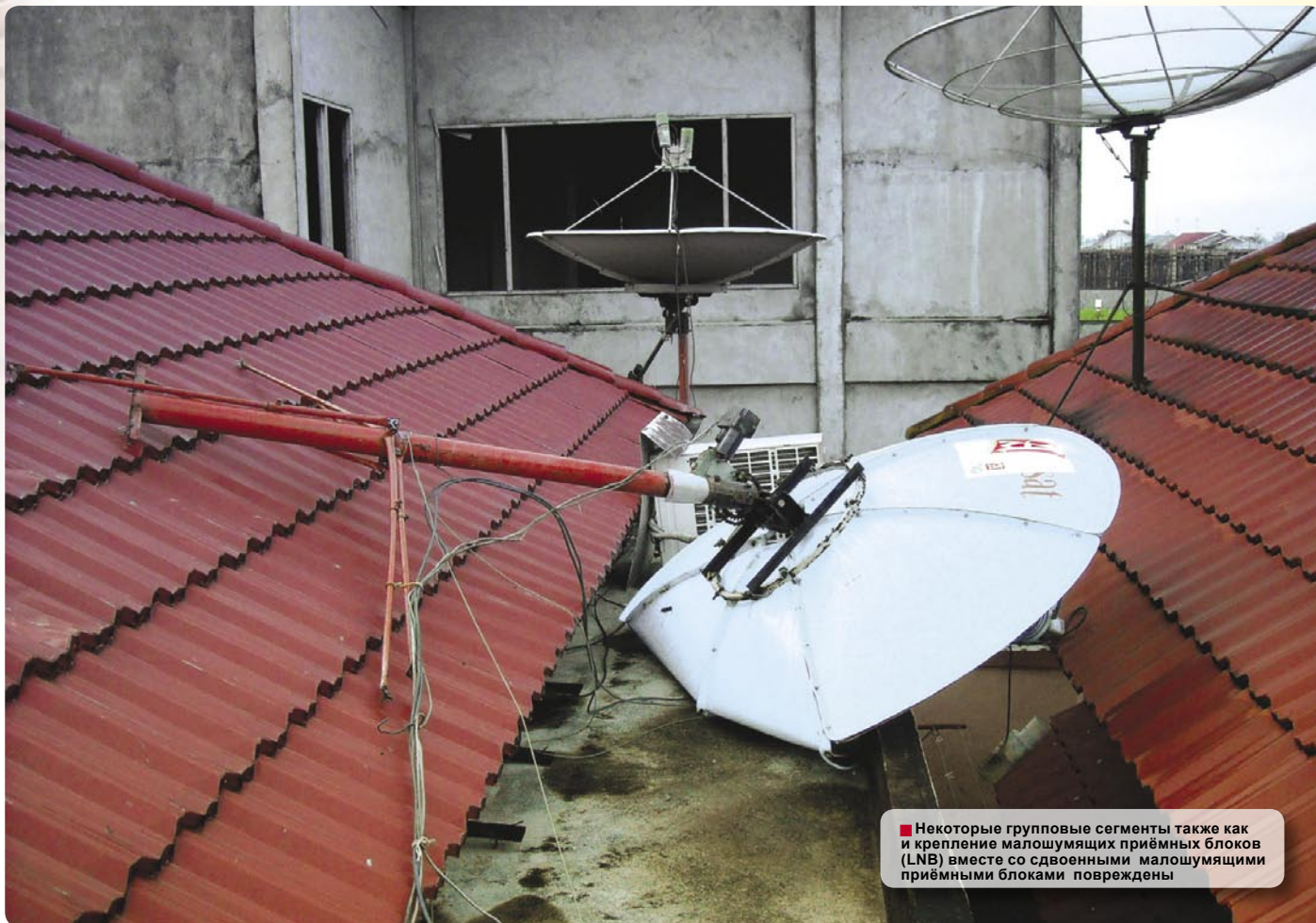
■ После шторма: Какая жалость - 1.8 метровая антенна разрушена из-за сильных ветровых нагрузок.
