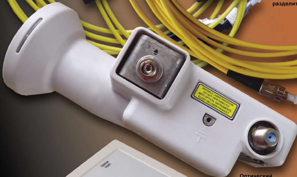
Оптический Цифровой выход и «F» соединитель для электропитания
