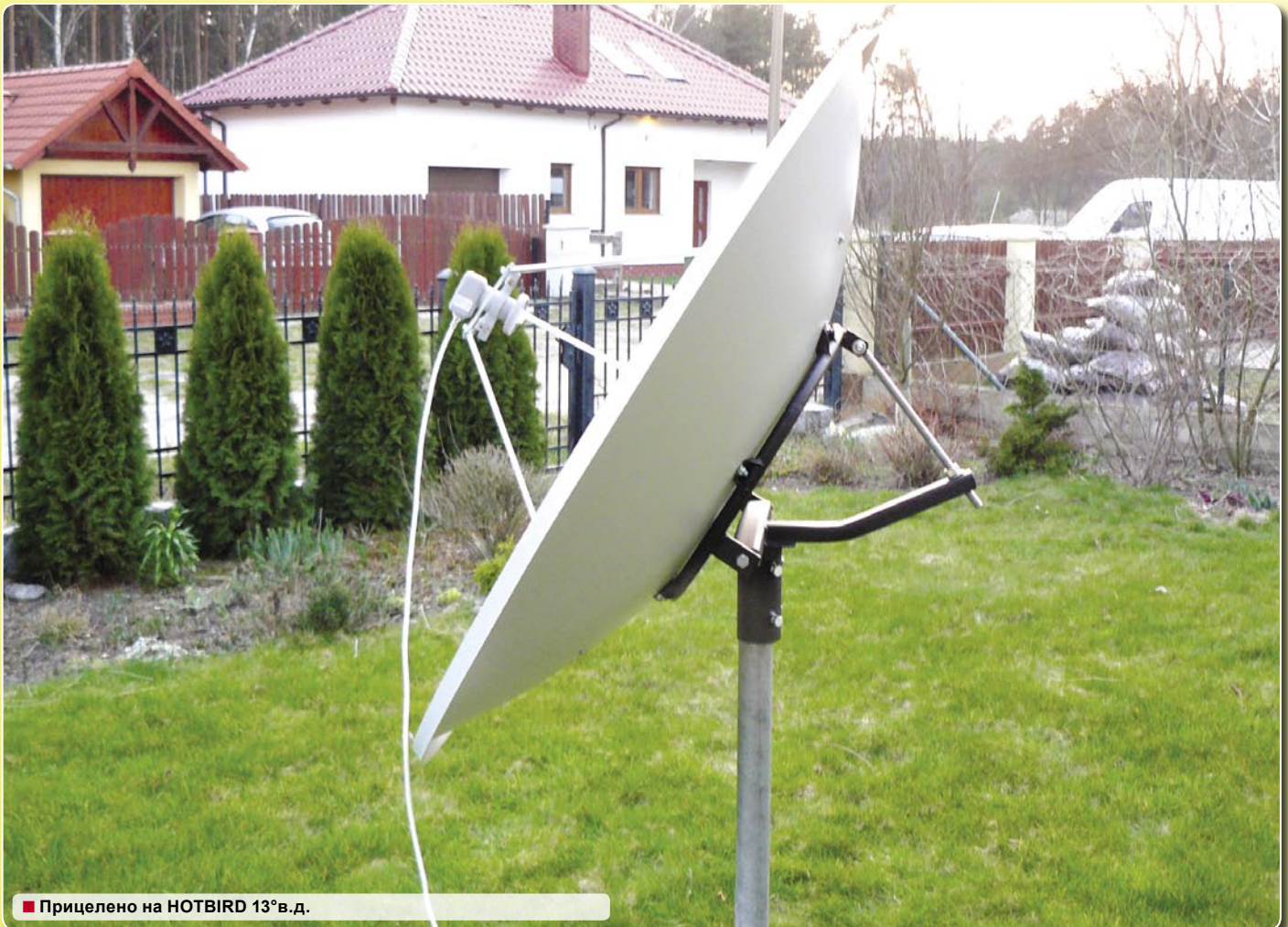
■ Это - держатель рупорного облучателя.
