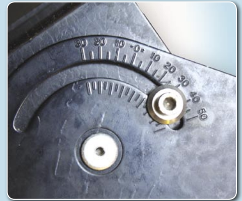
Значение угла возвышения, который установлен на антенне
