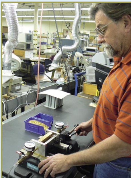
■ Билл Адамо (Bill Adamo) – Руководитель группы Контроля качества показывает нам, как атмосферно - непроницаемый оттиск фильтра проверяется давлением: «Фильтр помещен сюда и герметизируется воздухом в 5 PSI». Таким образом, они могут проверить, является ли внутренняя часть соединения, так же как его установка плотно прижата воздухом. «Наименьшая утечка может пропускать влажность в течение долгого времени и может изменить характеристики фильтра», говорит Билл Адамо (Bill Adamo), «Мы проверяем 100 % наших фильтров!» Каждый клиент может убедиться, что каждый фильтр МФК (MFC) соответствует своим высококачественным спецификациям.
