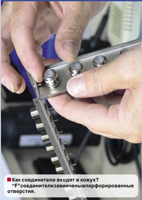
■ Монтажная плата привинчена к кожуху до отказа.
