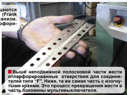
■ Откуда поступают монтажные платы? Из металлического корпуса, конечно же. Откуда эти корпуса идут? Из этого механизма, в котором имеется рулон жести шириной 36 мм, толщиной 0.7 мм со слоем покрытия никелем 0.02 мм. Новый рулон весит примерно 100 Кг и - 400 м в длину.
