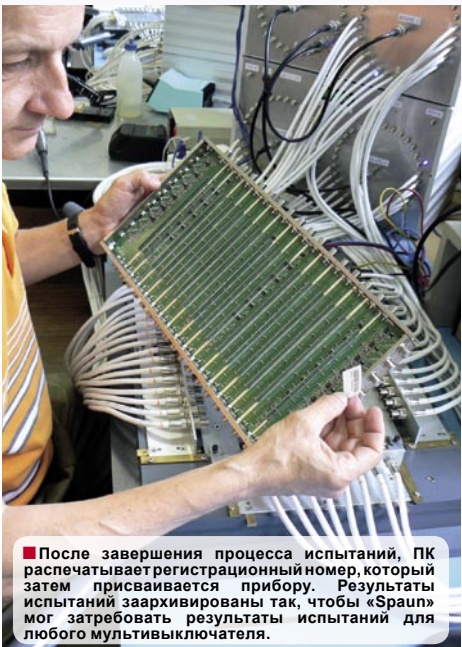
■ Каждый мультипереключатель проверен многократно на различных функциях. Мультипереключатель вмонтирован в эту испытательную станцию и перемещением единственного рычага, все "F" соединители сразу подключаются, и испытательный процесс может быть начат.
