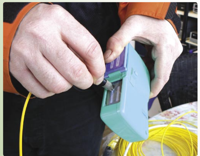
Несколько слов предостережения ко всем приспособлениям для установки соединителей: Не так просто в оптических кабелях собрать разъемы - до момента сборки контакты кабелей должны быть идеально чистыми и подготовленными. Различные методы могут использоваться, чтобы достигнуть этого; наиболее практичный использовать прибор, показанный здесь: в него вставляется соединитель оптоволоконного кабеля, и затем используется рычаг, для зачистки соединителя чрезвычайно мелкозернистой шкуркой, которая используется только один раз. Это единственный способ при установке гарантировать герметичную связь без затухания сигнала.
