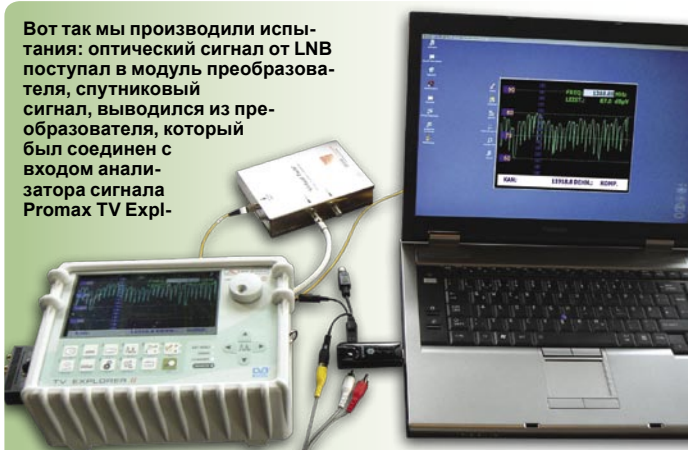
омер II. Выход, которого, затем соединен с нашим ноутбуком, для создания изображений протоколов измерения, опубликованных здесь.
